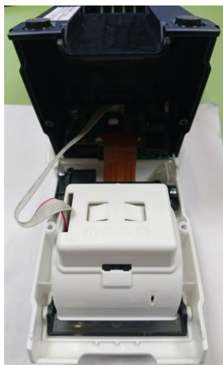
Рисунок 3. Демонтаж корпуса верхнего.
