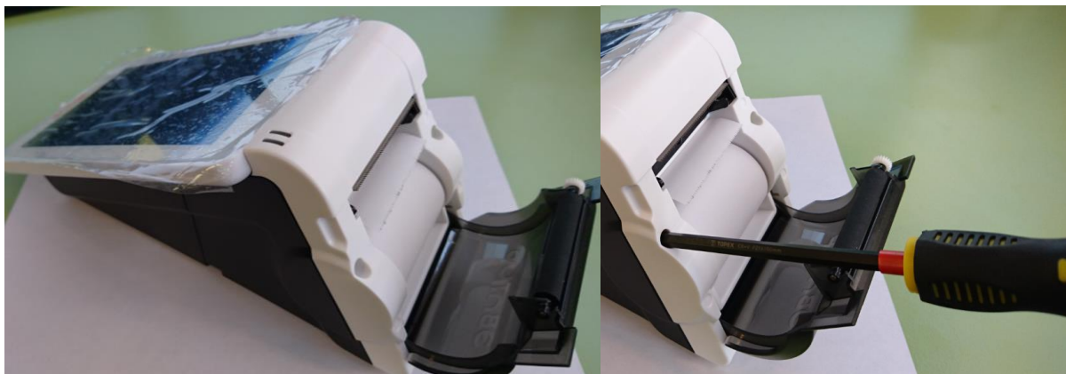
Рисунок 2. Винты крепления корпуса верхнего с корпусом нижним.
